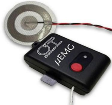
Figura 2. Elettromiografo impiegato per la registrazione della contrazione muscolare.
