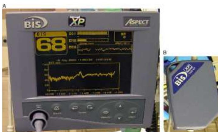
Figura 1. Il *device* BIS della Aspect Medical Systems Inc. (Natick, USA). In **A** è illustrato l'aspetto del monitor con l'indice bispettrale (nell'esempio 68), la traccia elettroencefalografica, elettromiografica e l'indice qualitativo del segnale, in **B** è illustrato il DSC (digital signal processing cable), che raccoglie i segnali elettroencefalografici e li trasmette al monitor
